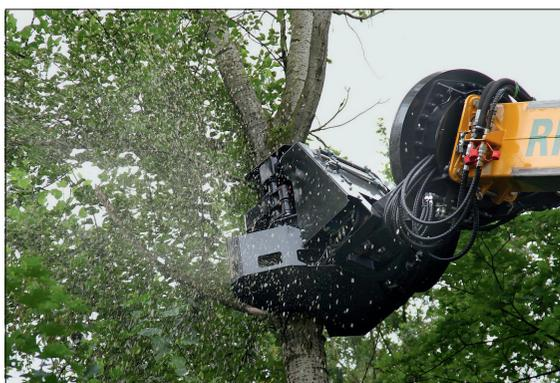
4. Trennschnitt mittels Kappsäge
