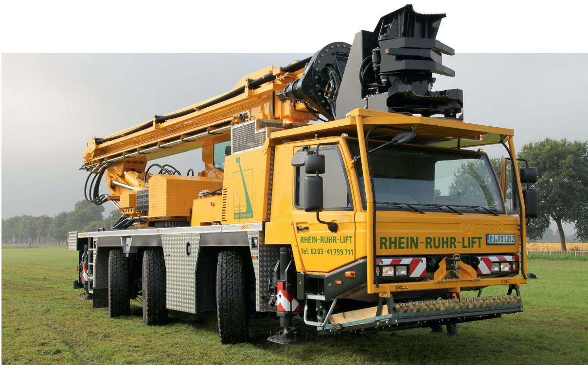
Die Allradlenkung ermöglicht präzises Rangieren auch bei schwierigen Verhältnissen
