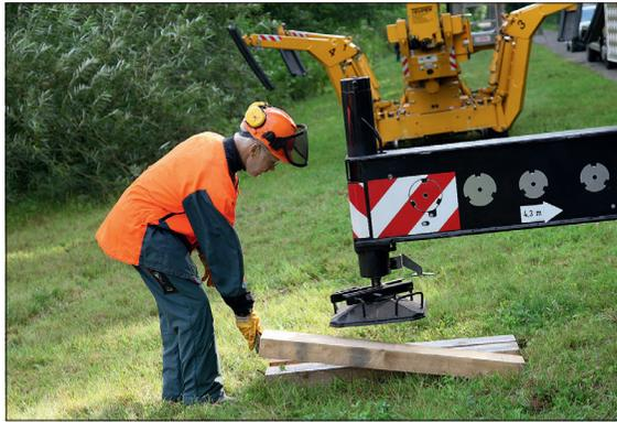
1. Aufbau stabiler Unterlagen für die Stützfüße
