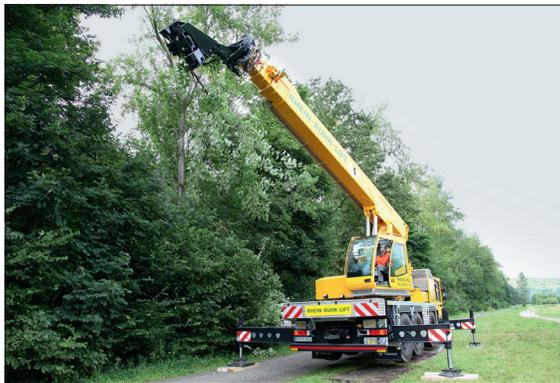
2. Abstützen der Maschine und Ausfahren des Teleskoparms
